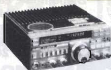
YAESU FT 757 GX II Ricetrasmittitore HF, FM, AM, SSB, CW, trasmissione e ricezione continua da 1,6 a 30 MHz, ricezione 0,1-30 MHz, potenza RF-200 W PeP in SSB, CW, scheda FM optional.
