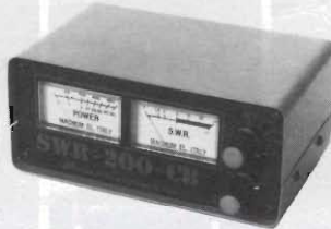
Wattmetro professionale 27 MHz - 1 kW
