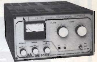
Amplificatore lineare 26-30 MHz; 800 W PeP AM-FM-SSB-CW
